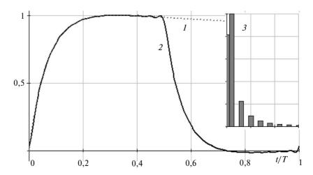
Рис. 3. Импульс тока (*1*) при единичной амплитуде импульса, периодизация (*2*), AЧХ (*3*)
