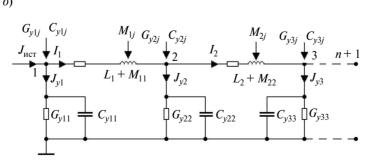
Рис. 1. Полевая (a) и цепная ( $\delta$ ) модели стержневого заземлителя
