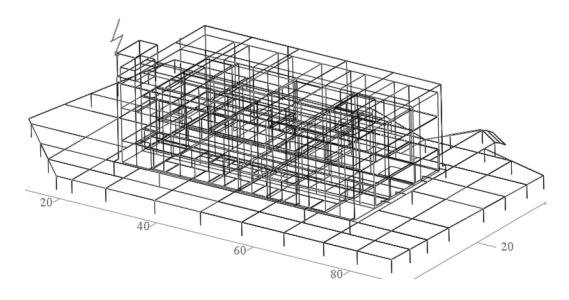
Рис. 5. Геометрическая модель ЗУ электрической подстанции с закрытым распределительным устройством
