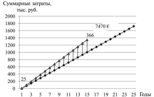
Рис. 4. Суммарные затраты и жизненный цикл установок (—◆— П.Б.; —▲— Т.Н.)
