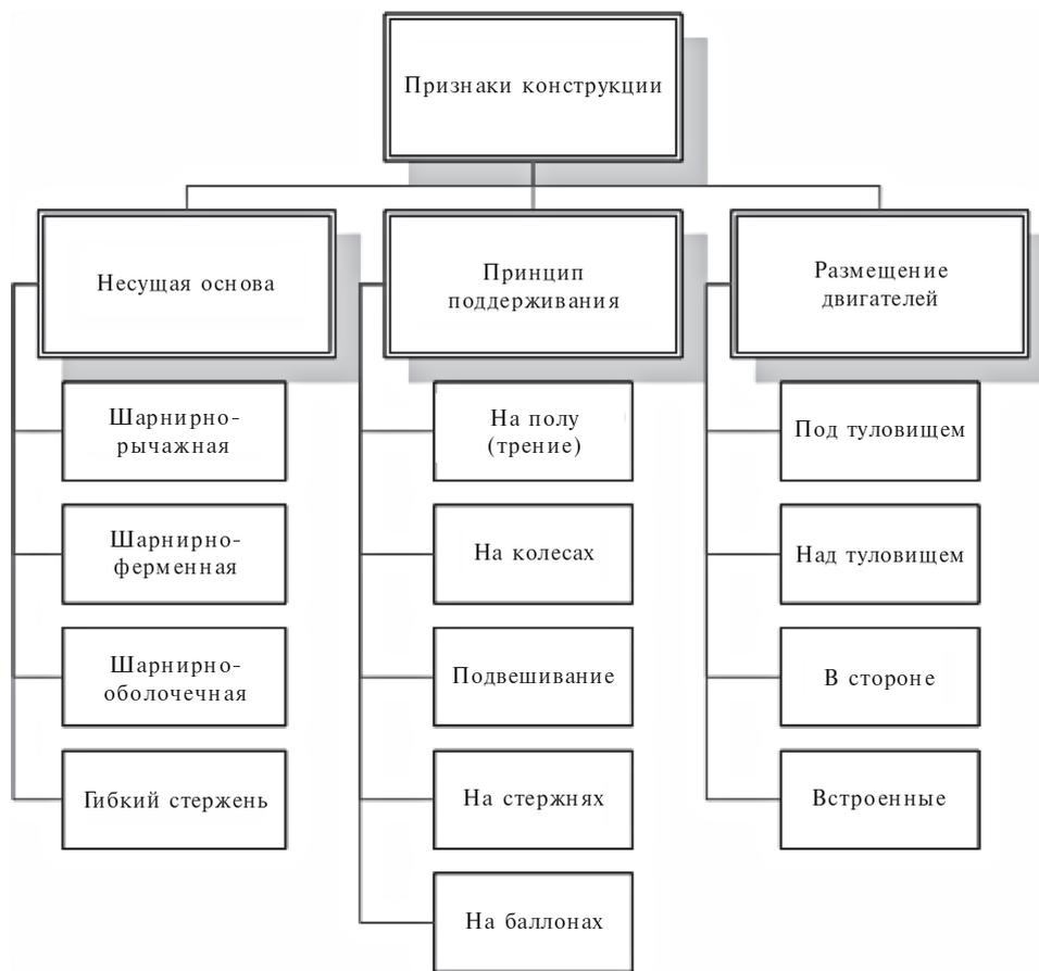
Рис. 1. Классификация конструкций демонстрационных роботов с изменяемой геометрией
