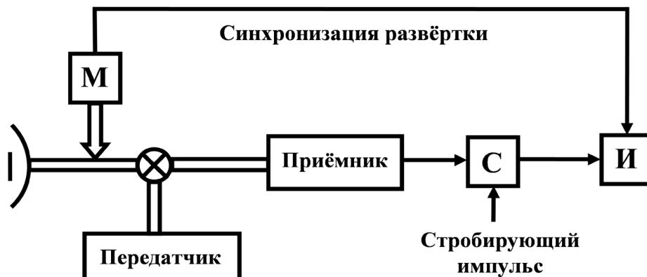
Рис. 1. Схема модернизации радиолокационной станции для селекции целей на фоне отражений от морской поверхности.
