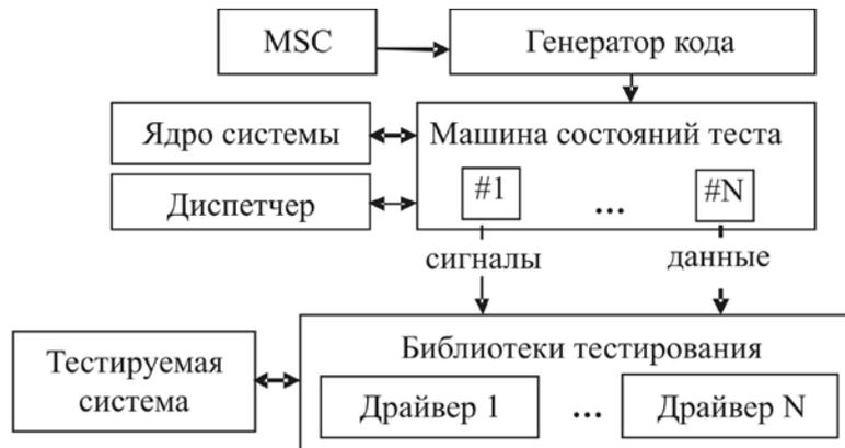
Рис. 2. Схема автоматизации тестирования на основе MSC
